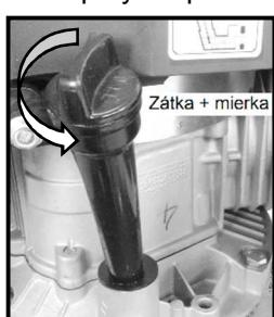
Umiestnite čerpadlo na vodorovný povrch. Otvorte zátku olejovej vane, na ktorej sa nachádza aj mierka oleja. Nalejte do motora približne  $\frac{3}{4}$  požadovaného množstva oleja. Zaskrutkujte zátku do motora. Pri polohe vypínača **B** v pozícii **OFF** (obrázok nižšie) pretočte motor potiahnutím za štartovaciu šnúru. Otvorte zátku, utrite mierku a skontrolujte hladinu motorového oleja.
